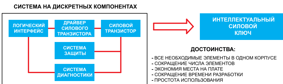
Рис. 1. Структурная схема интеллектуального силового ключа
