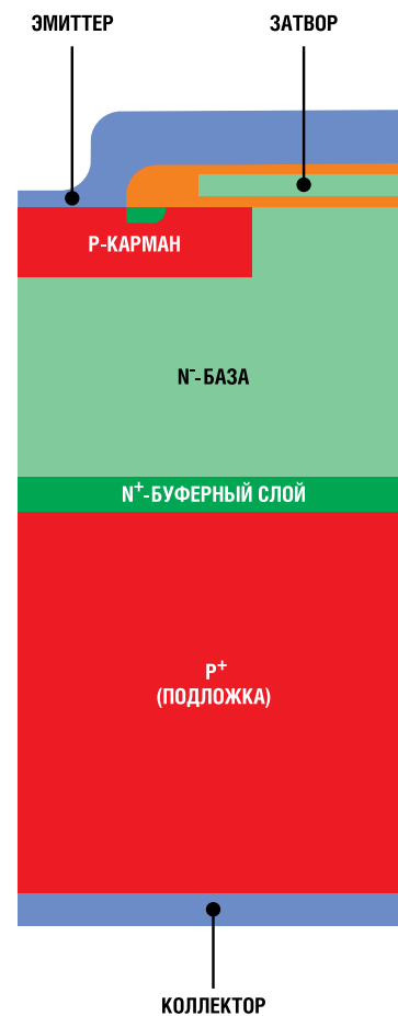
Рис. 2. Поперечный разрез биполярного транзистора с изолированным затвором (IGBT)
