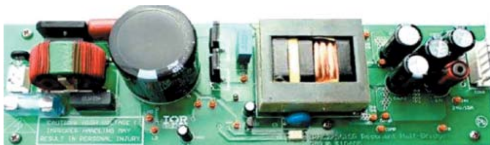
Рис. 8. IRAC27951SR-240W резонансный преобразователь с синхронным выпрямлением на базе IR1168
