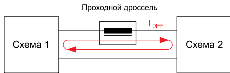
Рис. 4. Схема подавления дифференциальной помехи проходным дросселем
