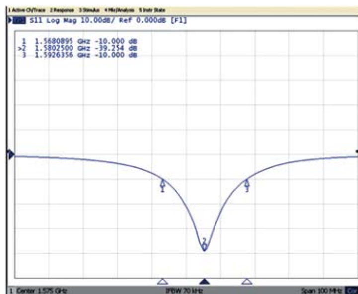
Рис. 10. График обратных потерь для GPS-антенны ANT2525B00BT1575A
