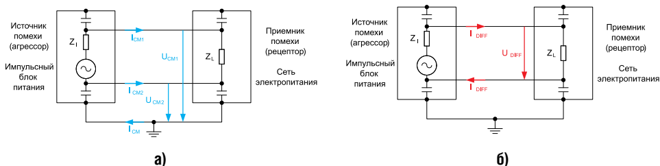
Рис. 1. Принцип проникновения синфазной (а) и дифференциальной (б) помехи в сеть электропитания
