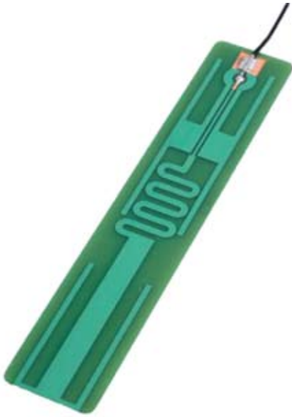
Рис. 4. Конструкция антенны на печатной плате
