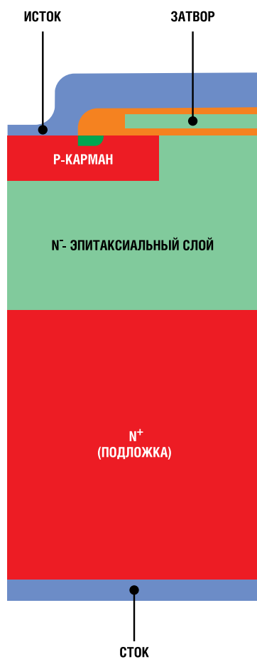
Рис. 1. Поперечный разрез кристалла классического MOSFET (вертикальный, с двойной диффузией)
