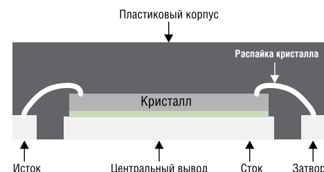
Рис. 2. Внутренняя структура PQFN корпуса на примере полевого транзистора
