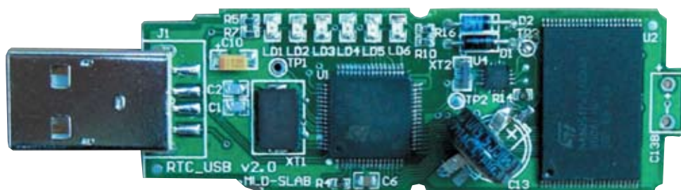
Рис. 2. Внешний вид платы STEVAL-SCM001V1
