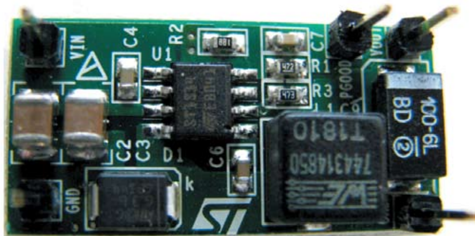
Рис. 9. Демонстрационная плата STEVAL-ISA104V1 на базе микросхемы ST1S14
