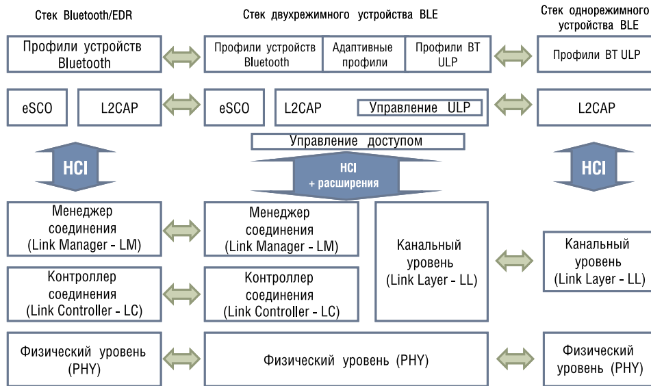
Рис. 2. Схема взаимодействия между однорежимными, двухрежимными устройствами и классическими Bluetooth-устройствами
