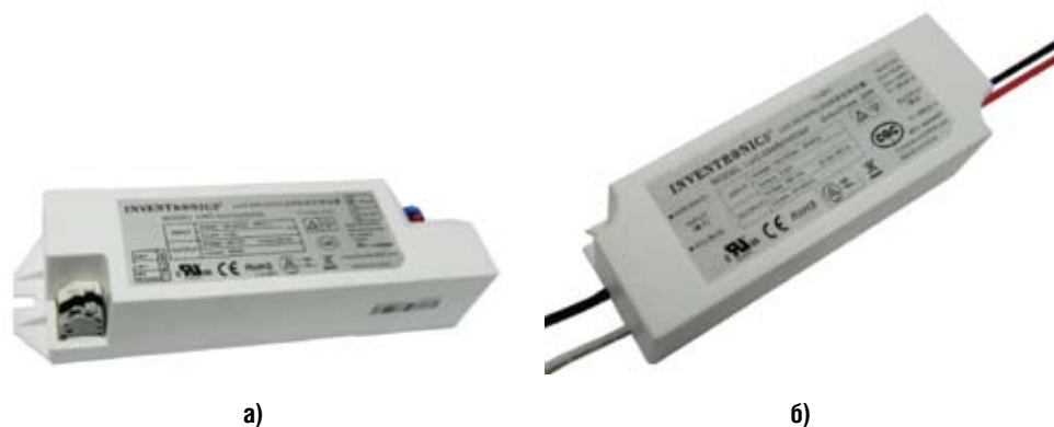
Рис. 8. Внешний вид корпусов драйверов серии LWC: а — вариант SSE с контактами под обжим, б — вариант SSP — с жестко фиксированными проводами
