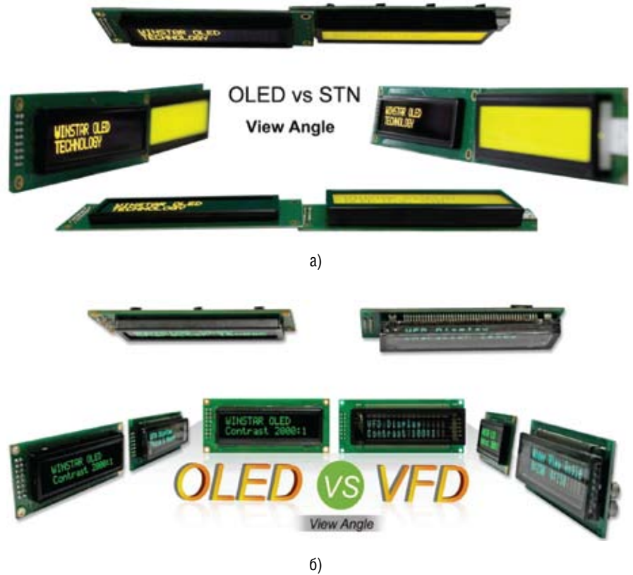
Рис. 8. Сравнение читабельности информации под большими углами обзора а) для LCD и OLED и б) для VFD и OLED
