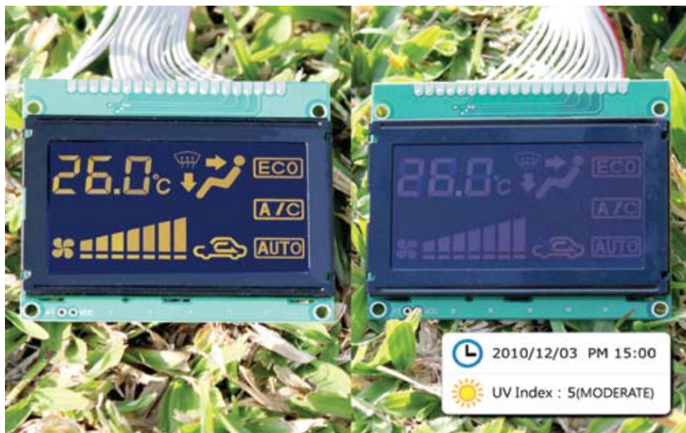
Рис. 7. Обычный (справа) и адаптированный (слева) для солнечного света OLED-дисплеи
