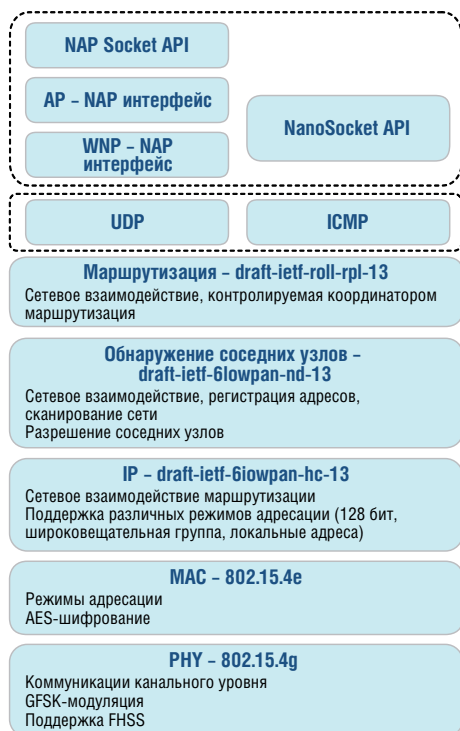
Рис. 4. Структура стека протоколов NanoStack lite 2.0
