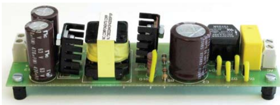
Рис. 4. Внешний вид модуля электронного балласта для светодиодных светильников
