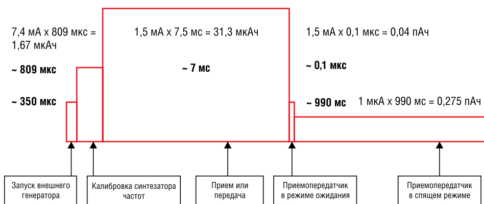
Рис. 3. Пример профиля энергопотребления беспроводного узла
