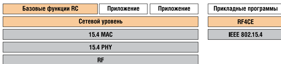
Рис. 6. Структура стека протоколов RemoTI
