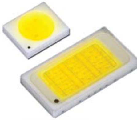
Рис. 5. Светодиоды без первичной оптики
