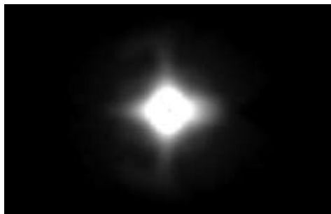
Рис. 4. Пространственное распределение силы света линз KNATOD
