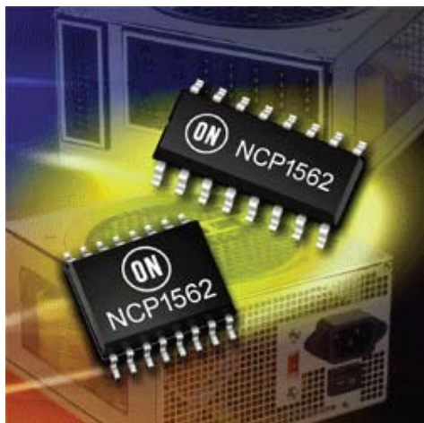
Рис. 1. Общий вид ШИМ-контроллера NCP1562
