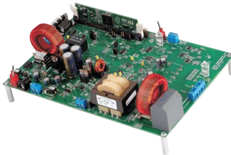
Рис. 6. Вид платы из набора TMDSENTRYKIT
