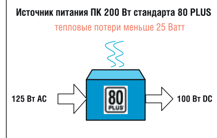
Рис. 2. Эффективность преобразования обычного ИП и стандарта 80 PLUS Gold
