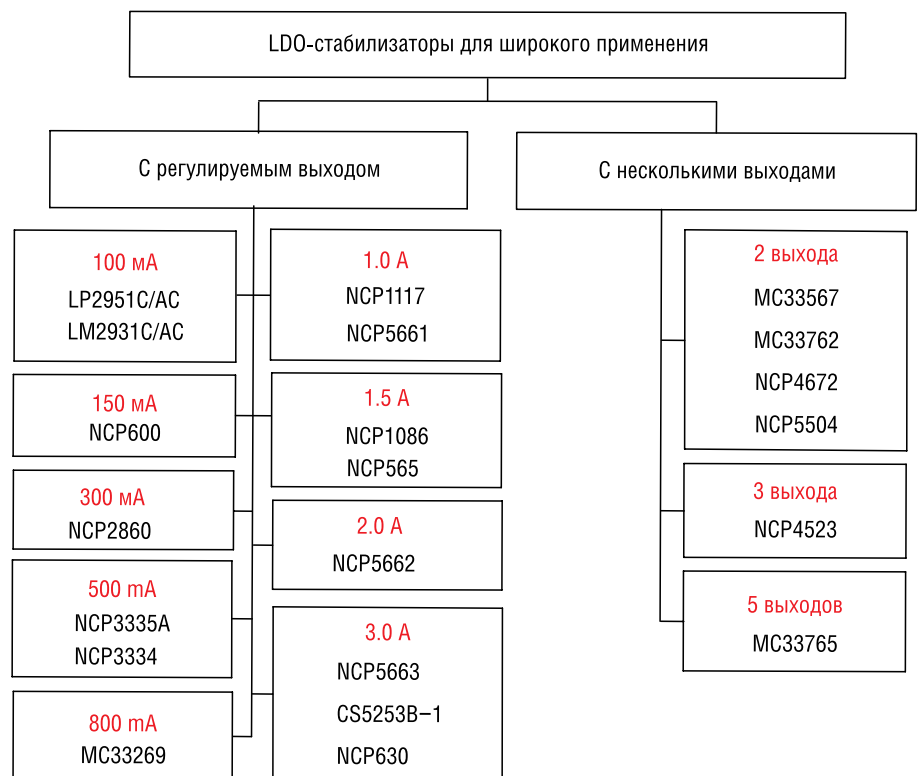
Рис. 3. LDO-стабилизаторы ON Semiconductor с регулировкой выходного напряжения и с несколькими выходами
