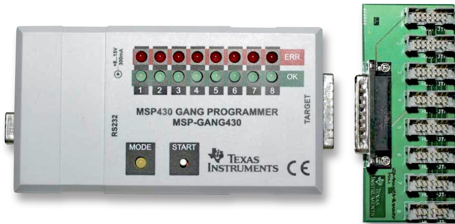
Рис. 9. Промышленный внутрисхемный программатор MSP-GANG430
