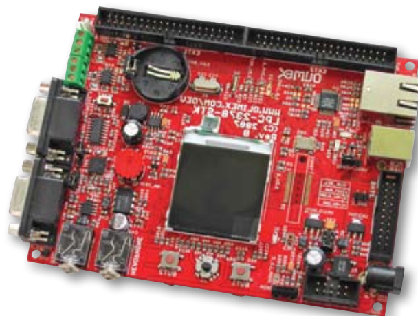
Рис. 3. Вид комплекта отладки и начального ознакомления Olimex LPC-P2378
