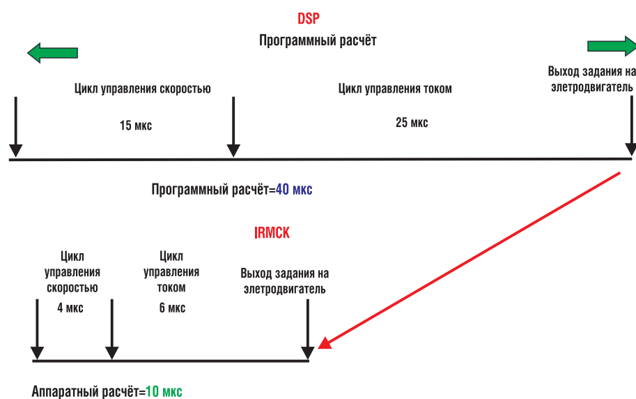
Рис. 1. Сравнение программной и аппаратной реализации времени расчета полного цикла управления по току и скорости
