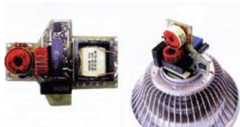
Рис. 3. Слева – компоновка элементов схемы преобразователя, справа – размещение платы драйвера в цоколе лампы E27
