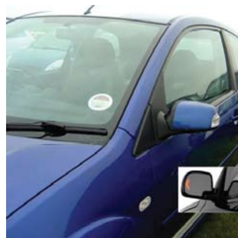
Рис. 5. Дублирующие сигналы поворота на крыле, зеркале бокового обзора снаружи и внутри (подсвечиваемая стрелка)
