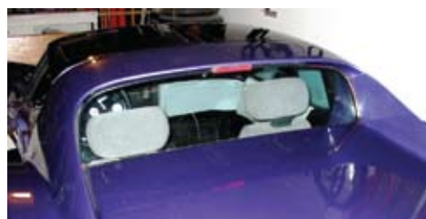
Рис. 3. Светодиодный центральный стоповый сигнальный фонарь
