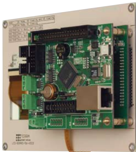
Рис. 4. Микроконтроллерная система на основе TE-ULCD56 и TE-STM32F107
