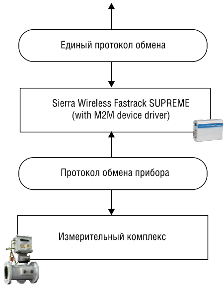
Рис. 2. Структура программного взаимодействия контроллера АКЦИС
