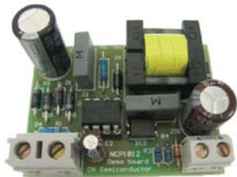
Рис. 5. Оценочная плата импульсного ИП на основе NCP1012
