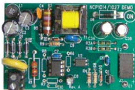
Рис. 6. Драйвер светодиодов с током управления 720 мА и ограничением напряжением на уровне 18 В
