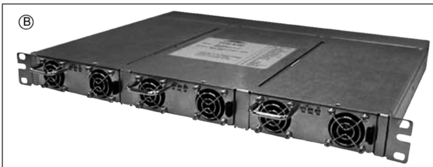
Рис. 3. Внешний вид модуля питания (а), корзины (б) и комплектного ИП для монтажа на стойку (в)
