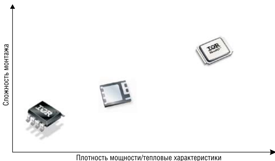
Рис. 1. Зависимость сложности монтажа корпусов SO-8, PQFN и DirectFET от их теплоотсеивающих свойств
