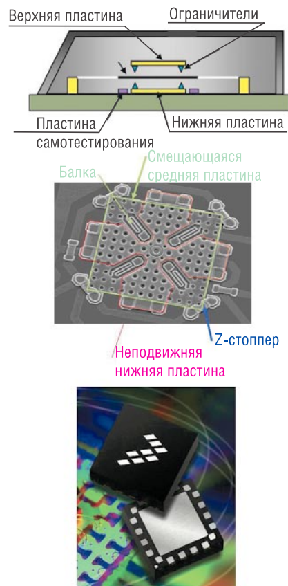
Рис. 2. Конструкция полупроводникового инерциального датчика
