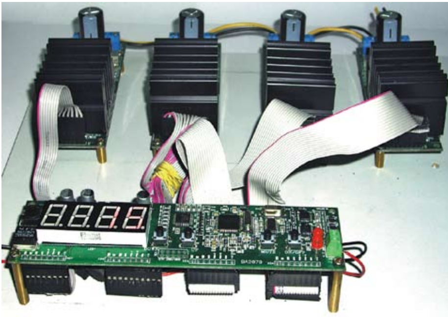
Рис. 4. Реализация 4-канального цифрового HiFi-усилителя
