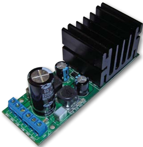
Рис. 2. Внешний вид одноканального оконечного усилителя D-класса 315 Вт
