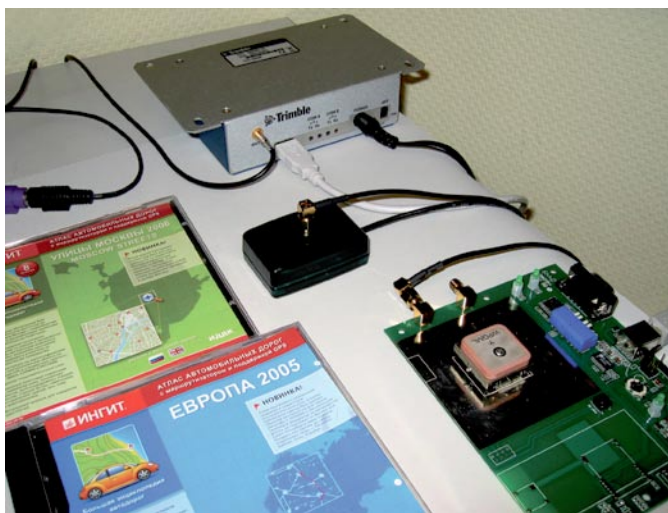
Рис. 6. Статический тест трех GPS-приемников
