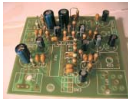
Рис. 9. Монтируем «более капризные в монтаже» электролитические конденсаторы, их нужно не перегреть паяльником
