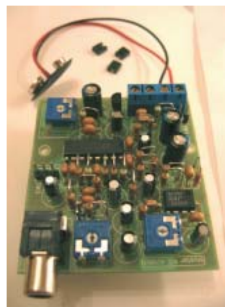
Рис. 12. Последний штрих: разъемы, джамперы и колодки
