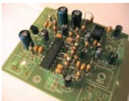
Рис. 10. Очень аккуратно устанавливаем транзисторы и паяем микросхему
