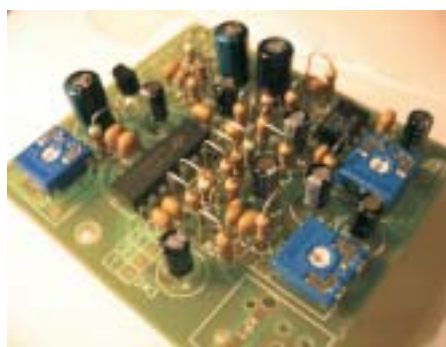
Рис. 11. Устанавливаем подстроечные резисторы
